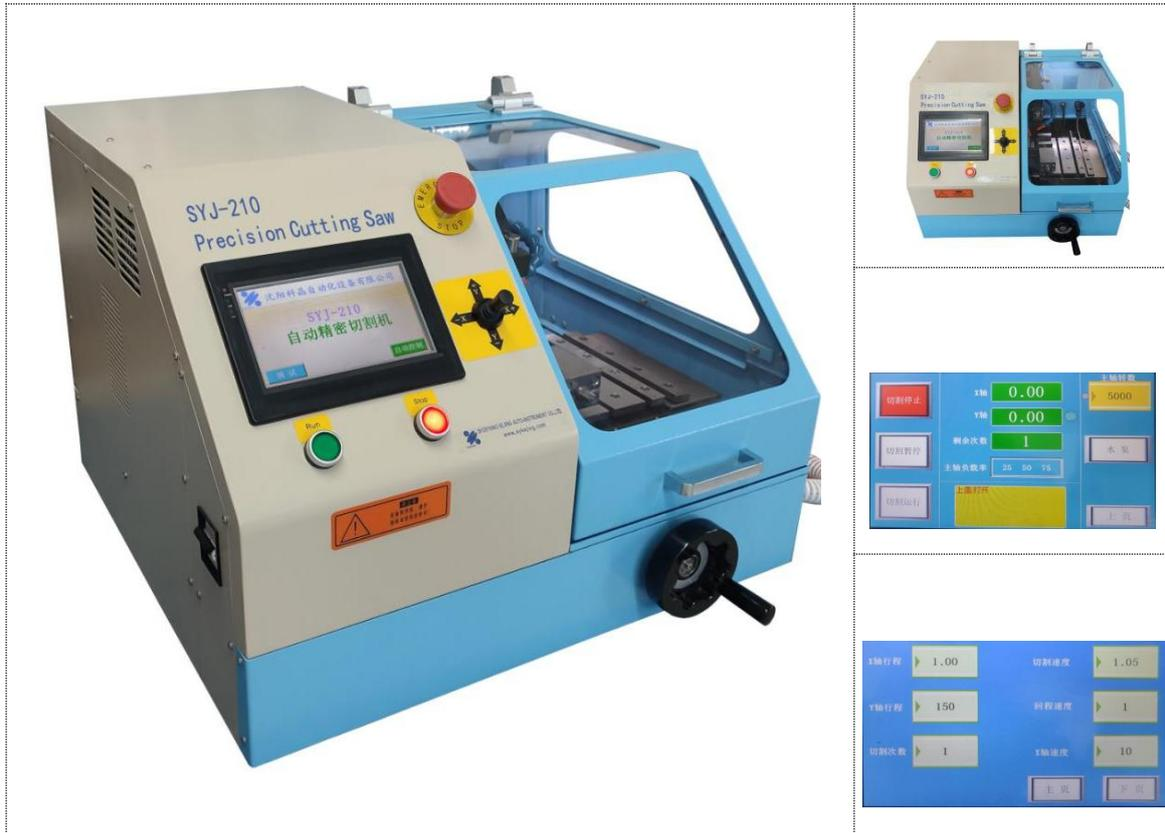
SYJ-210 全自动精密切割机，它是针对市场的需求而设计的，广泛应用于大专院校和研究院所。适合金属、陶瓷、玻璃、岩样、矿样、混凝土、有机材料的高速切割。
