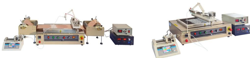
MSK-ESC-R2R 是一款桌面型静电纺丝系统，配有卷对卷机构，可对成卷的基底连续静电纺丝，也可对单片基底静电纺丝。设备主要组成有：自动卷对卷机构，0-30KV 电压可调的高压电源，注射泵，加热型真空板，5 针头纺丝喷头和往复机构。此套系统集成量纳米纺丝，涂层烘烤和收集为一体。
