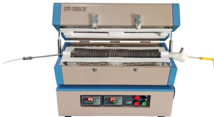
OTF-1200X-25 是一款气体加热炉，加热炉最高温度可达 1100℃，可设置 30 段升温程序。采用不锈钢管作为气体加热的载体，出气口包裹着保温棉，使得气体的最高温度可达 700℃
